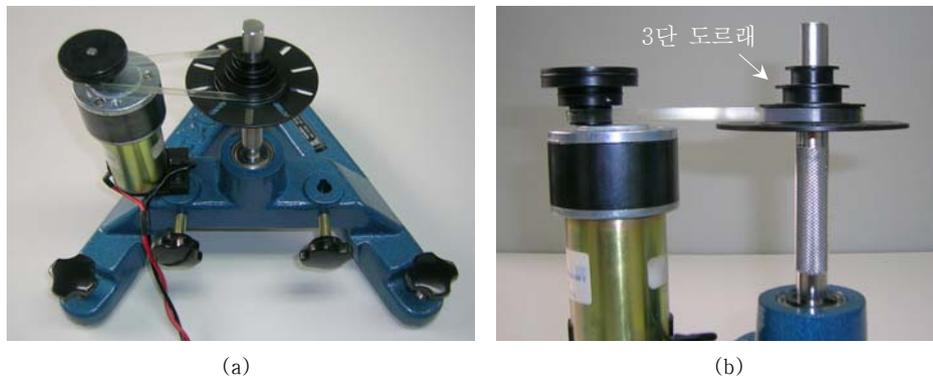
그림 4. (a) 회전스탠드에 DC 모터를 장치한 상태. (b) 고무밴드를 구동축에 수평하게 연결한다.
